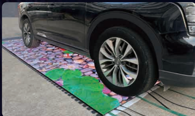
汽车承重测试 1m 2 承重1000kg
